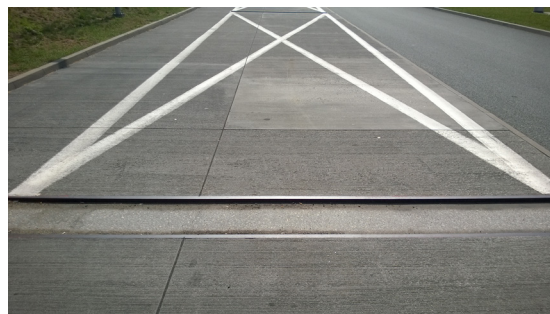
Rys. 5. Stanowisko do wyznaczania masy pojazdu wagami, podlegającymi prawnej kontroli metrologicznej, na autostradzie A2 – kierunek Świecko
