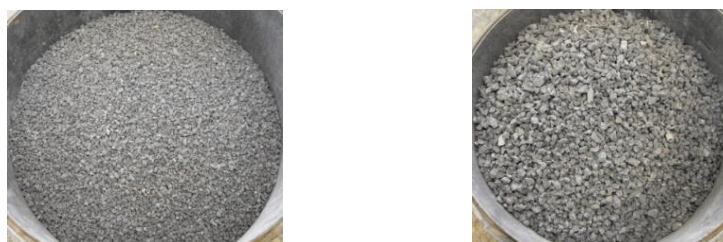
Rys. 1. Widok kruszywa wtórnego uzyskanego z próbek betonu BWW, frakcje 2–4 oraz 4–8 mm
