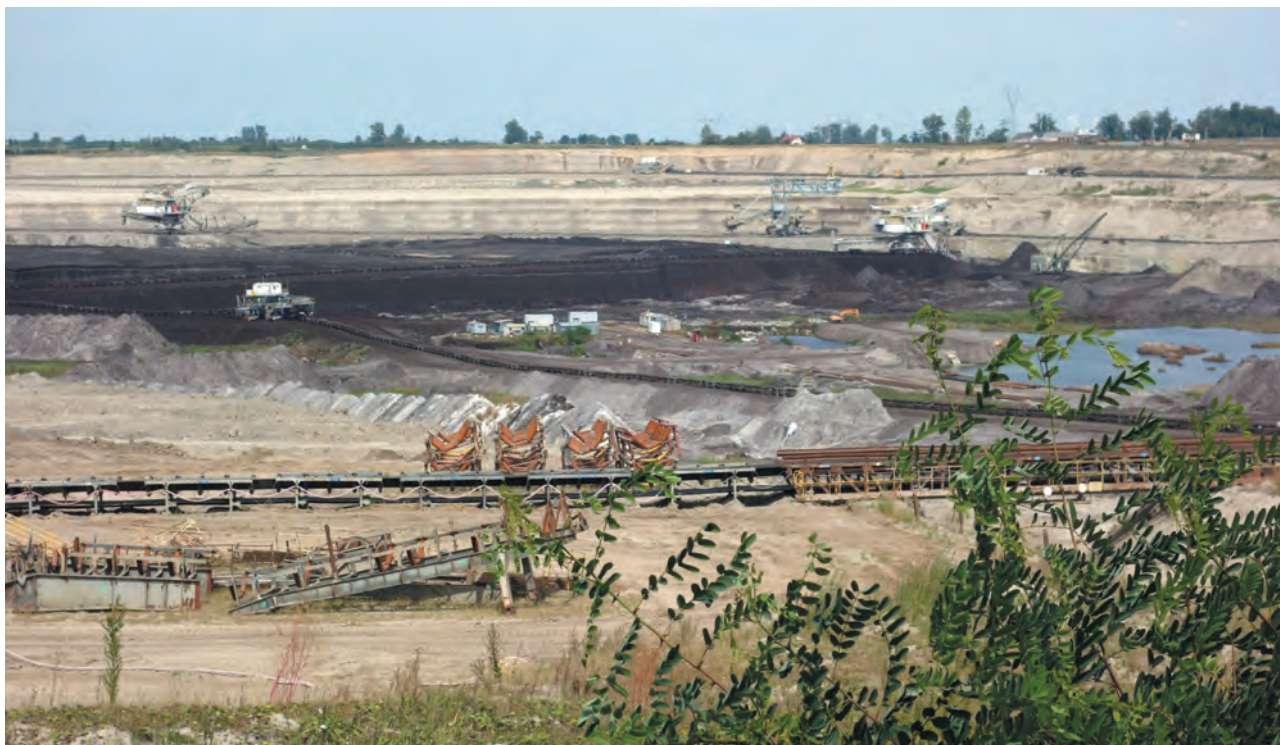
Ryc. 10. Odkrywka węgla brunatnego Tomisławice z systemem odwodnienia spągowego – rząpiec w środkowej części fotografii. Fot. M. Widera, czerwiec 2019 r.
