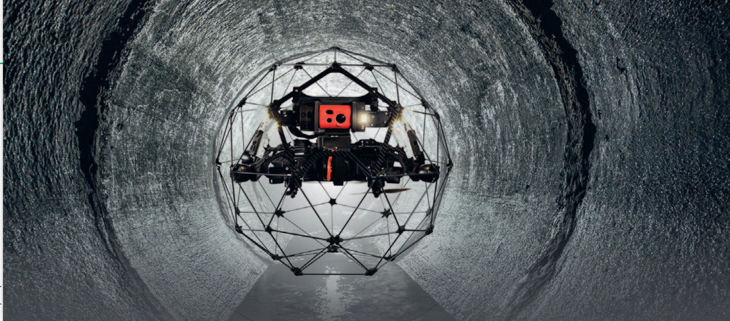
Drony z serii Elios zaprojektowano specjalnie z myślą o inspekcjach zamkniętych przestrzeni
