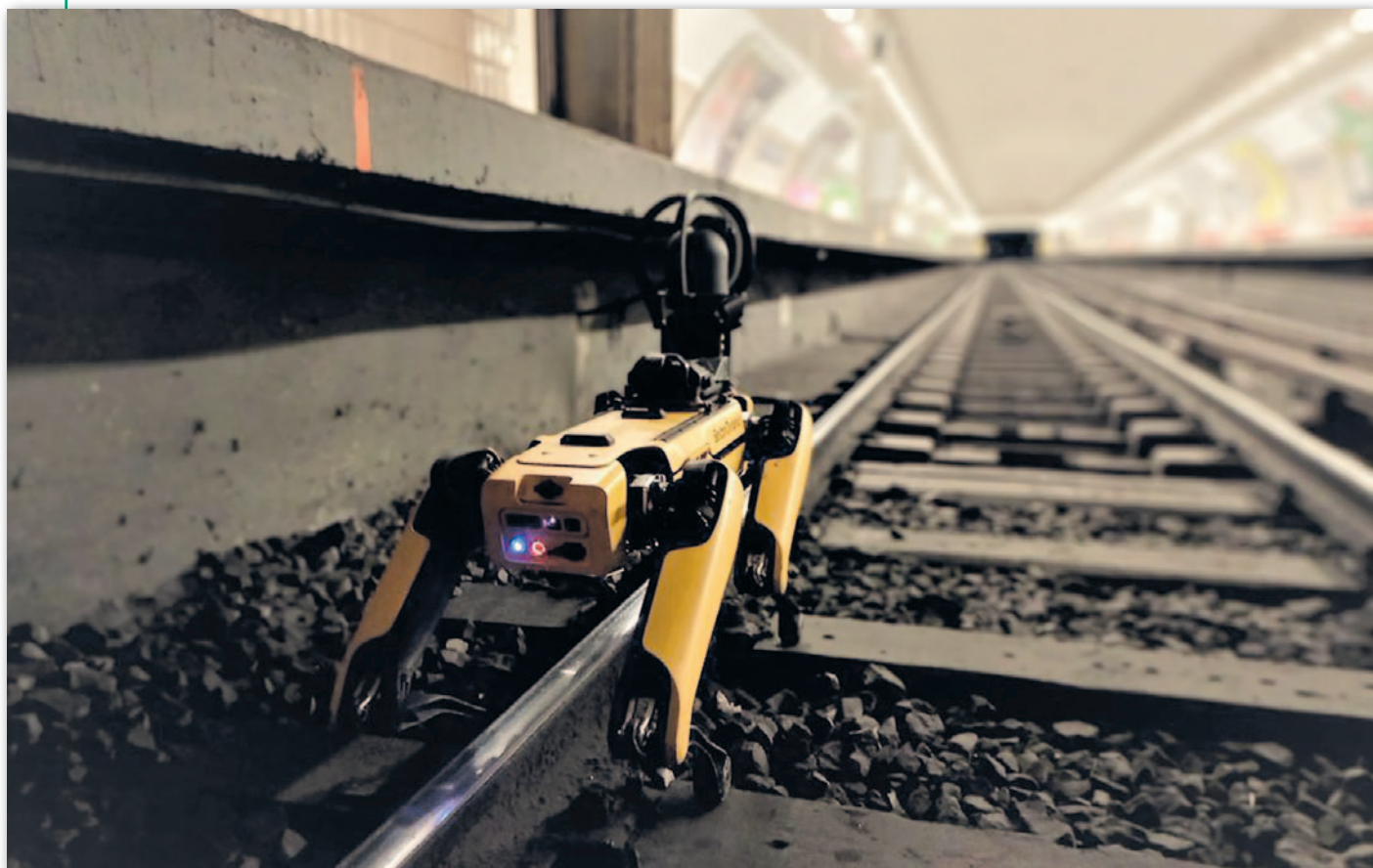
Perceval w trakcie inspekcji jednej ze stacji paryskiego metra
