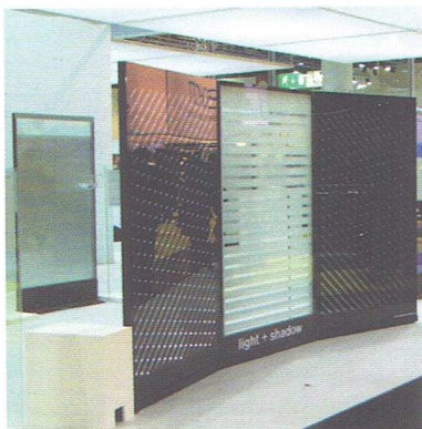
Rys. 4. Panele ze szkła laminowanego z diodami LED oraz z warstwami ciekłokrystalicznymi (Priva-Lite, Saint Gobain) zasilanymi poprzez warstwę elektroprzewodzącą na szkło, jako przykłady szkieł o funkcjach ulegających dynamicznym zmianom za pośrednictwem sterowania napięciem elektrycznym, (Glasstec, 2008)
