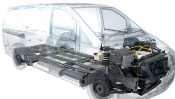
Rys.3. Zespół napędowy w samochodzie dostawczym Vito E-CELL z akumulatorami umieszczonymi pod powierzchnią ładunkową [8]
