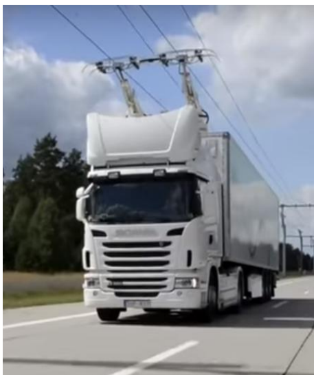
Rys.10. Ciężarówka z napędem hybrydowym Scania – energia elektryczna pobierania z linii napowietrznej [19]
