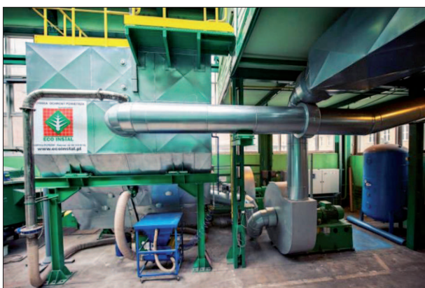
Rys. 2. Modułowy, pionowy filtr ceramiczny z wkładami typu Cerafil TopKat1500
