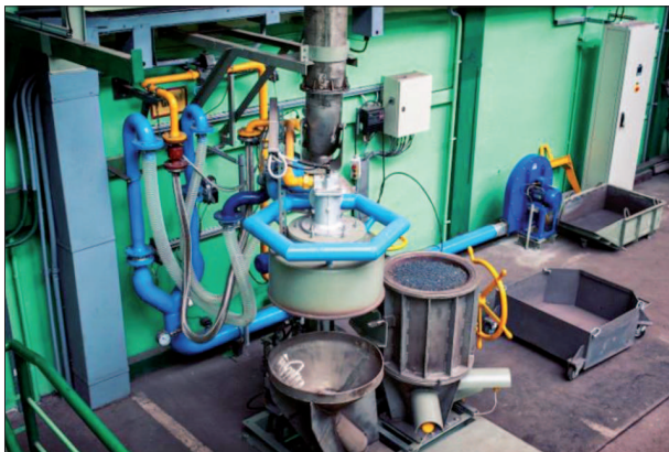
Rys. 1. Linia do półprzemysłowej symulacji procesu spiekania rud żelaza i odpadów z wykorzystaniem nowatorskiego systemu neutralizacji spalin (LS)
