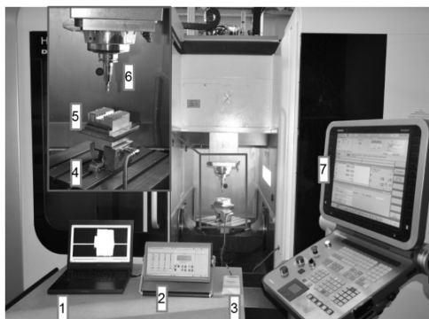
Rys. 4. Stanowisko badawcze: 1- komputer multimedialny, 2- wzmacniacz ładunku, 3- 24-bit przetwornik A/C, 4- trzy składnikowy siłomierz piezoelektryczny, 5- badana próbka, 6- frez, 7- pulpit sterownika CNC z systemem Artis Fig. 4. Experimental setup: 1- multimedia computer, 2- charge amplifier, 3- 24-bit A/D converter, 4- three-component piezoelectric dynamometer, 5- test sample, 6- mill cutter, 7- desktop of CNC controller with ARTIS system
