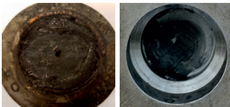
Fot. 3. Dysza węglowa po próbie szczelinowania nr 2
