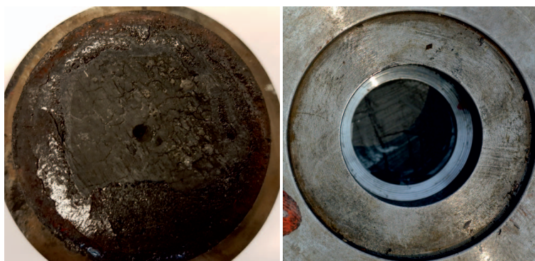
Fot. 2. Dysza węglowa po próbie szczelinowania nr 1
