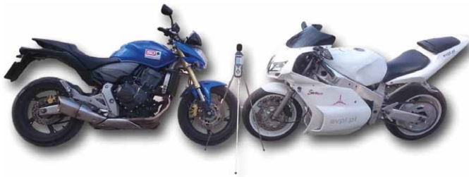
Rys. 11. Porównanie hałasu emitowanego przez motocykl z napędem spalinowym (moto. spalin.) i motocykl z napędem elektrycznym (moto. EV)
