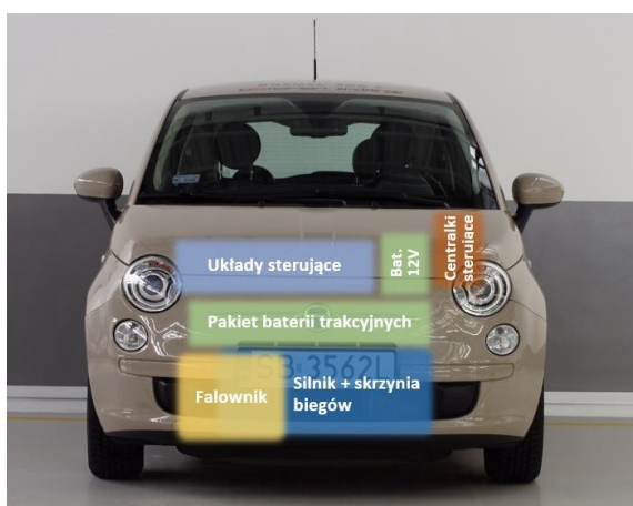
Rys. 3. Rozmieszczenie komponentów napędu elektrycznego - widok z przodu
