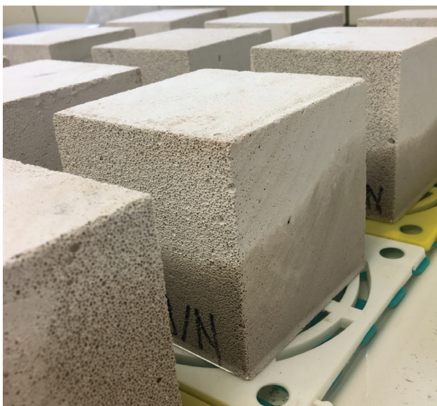
Rys. 1. Przebieg badania podciągania kapilarnego służącego do wyznaczenia współczynnika sorpcji wody A [ \text{kg}/(\text{m}^2\text{h}^{0,5}) ]
