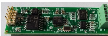
Rys. 8. Zobrazowano: a) schemat blokowy AD5933 [15]; b) widok modułu ewaluacyjnego z optoizolacją i programowalną zmianą zakresu pomiarowego (cewka pomiarowa podłączana poprzez złącze).
