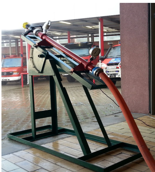
Ryc. 6. Widok prężownicy zamontowanej Fig. 6. A view of the nozzle mounted on a stand
