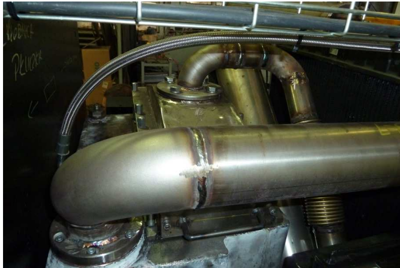
Rys. 6. Zespoły układu wylotowego silnika spalinowego w wykonaniu przeciwwybuchowym [6]
