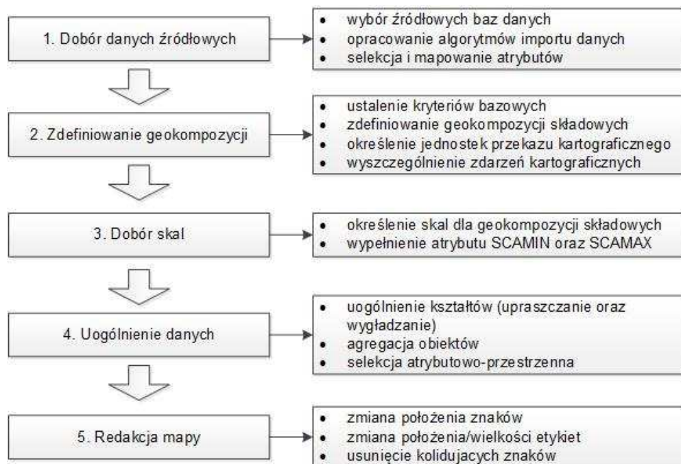
Rysunek 1. Model generalizacji danych w MOBINA (Kazimierski, Włodarczyk-Sielicka, 2016)
