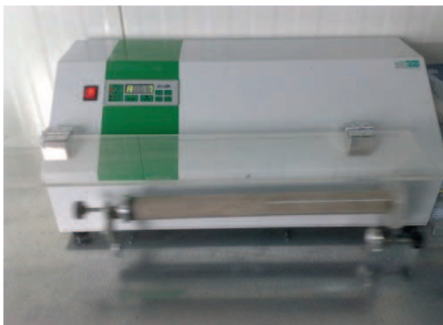
Rys. 2. Urządzenie - wstrząsarka, na której wykonywano badanie Fig. 2. Shake machine used in the research
