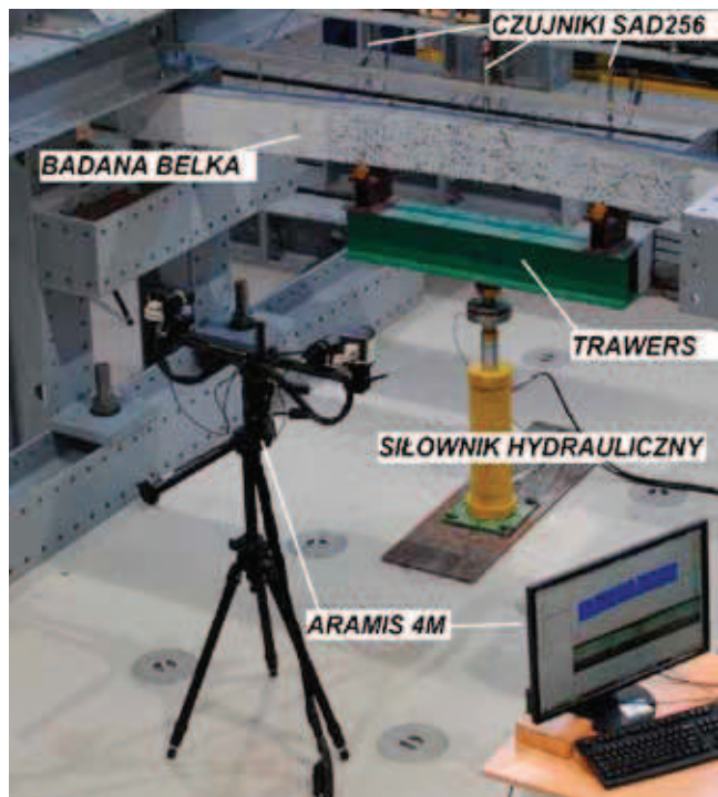
Rys. 3. Ogólny widok stanowiska badawczego z systemem ARAMIS 4M
