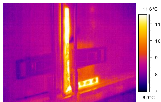
Rys. 8. Skutki „naprawy” uszkodzeń krawędzi drzwi współczynnika przenikania ciepła nadwozia - test ATP.
