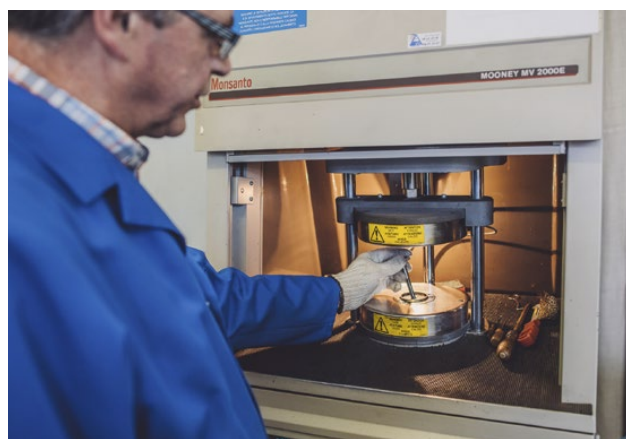
Rys. 8. Badanie reometrem (archiwum Łukasiewicz – IMPiB)
