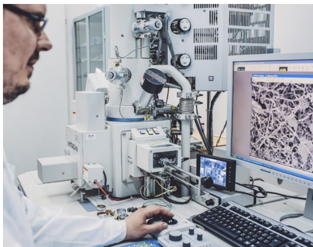
Rys. 4. Skaningowy mikroskop elektronowy w Laboratorium Polimer (archiwum Łukasiewicz – IMPiB)
