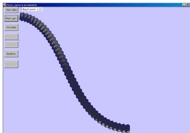
Rys. 3. Wygenerowany w programie Rzwp model przewodu z fałdami o długości fali 0,008 m i amplitudzie 0,0035 m Fig. 3. The tube model with corrugations of wavelength 0,008 m and amplitude 0,0035 m generated in program Rzwp
