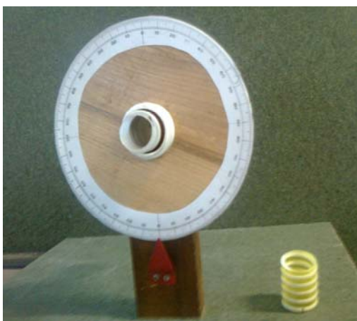
Rys. 2. Stanowisko do pomiaru współczynnika tarcia ziarna o ścianki przewodu Fig. 2. Research stand for measurements of friction coefficient of the grain on the side of a tube
