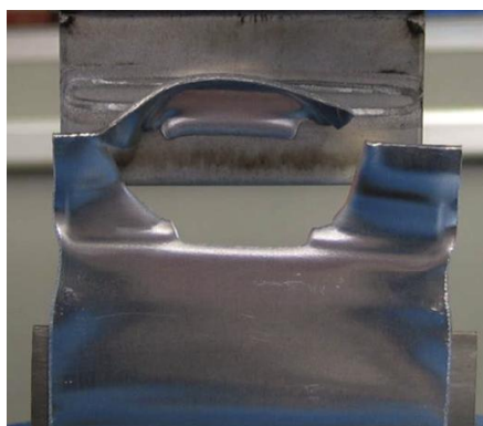
Rys. 22. Wyniki testu wytrzymałościowego połączenia zgrzewanego blach w technologii EMPT: materiał EN AW-6060/TRIP700; grubości 1,0/1,5 [6]
