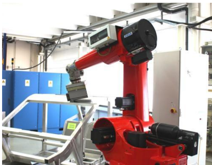
Rys. 9. Prototypowe stanowisko montażu z wykorzystaniem zgrzewania elementów nadwozia samochodowego w technologii EMPT firmy PST products GmbH [6]
