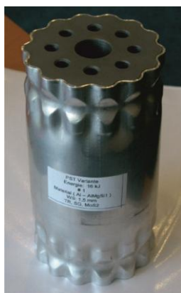
Rys. 17. Dwustronne uformowanie zamknięcia obudowy ze stopu aluminium [6] Fig. 17. Double sided forming of casing lid made of aluminum alloy [6]
