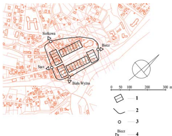
Ryc. 8. Próba rekonstrukcji układu urbanistycznego miasta lokacyjnego w Grybowie w oparciu o wielkość działki lokacyjnej na tle modularnej siatki mierniczej opartej na module 1 sznura i wielkości stopy równej 0,32 metra długości. Opracowanie autora. Legenda: 1 – bloki i pasma budowy siedliskowej z podziałem na poszczególne parcele o wielkości 50 × 125 stóp, 2 – hipotetyczny przebieg linii umocnień miejskich, 3 – bramy lub furty, 4 – główne kierunki powiązań komunikacyjnych średniowiecznego Grybowa
