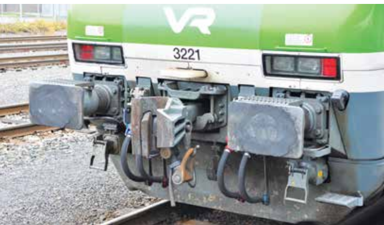
Sprzęg LAF (UIC+SA-3) w lokomotywie VR (3221)
