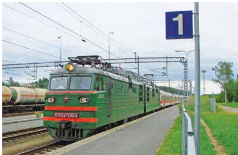
WL82M-065 (3 kV DC 25 kV 50 Hz) należąca do RŽD z pociągiem Sibelius (tabor VR) relacji Helsinki–St. Petersburg na stacji granicznej Vainikkala (28.07.2008 r.). Fot. I. Siissalo
