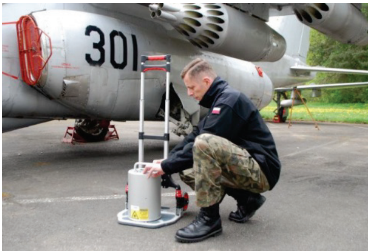
Rys. 4. Urządzenie ELATextur do pomiaru makrotekstury [źródło: archiwum ITWL]
