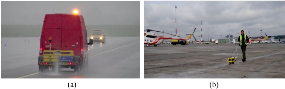
Rys. 2. Tester tarcia ASFT na przyczepie T-10 (a); ręczny, przenośny tester tarcia ASFT typu T2Go (b) [źródło: archiwum ITWL]
