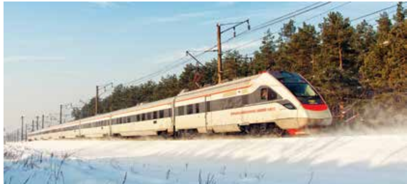
Pociąg zespolony Tarpan serii EKr1 (3 kV DC, 25 kV 50 Hz) (26.12.2012 r.). Fot. A. Kozłowska
