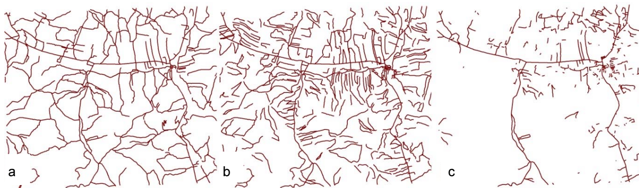
Rys. 7. Drogi wybrane dla poziomu szczegółowości 1:50 000: a – manualnie wg danych porównawczych, b – za pomocą reguł rozmytych utworzonych z wykorzystaniem reduktów, c – za pomocą reguł rozmytych z wyborem atrybutów przez operatora
