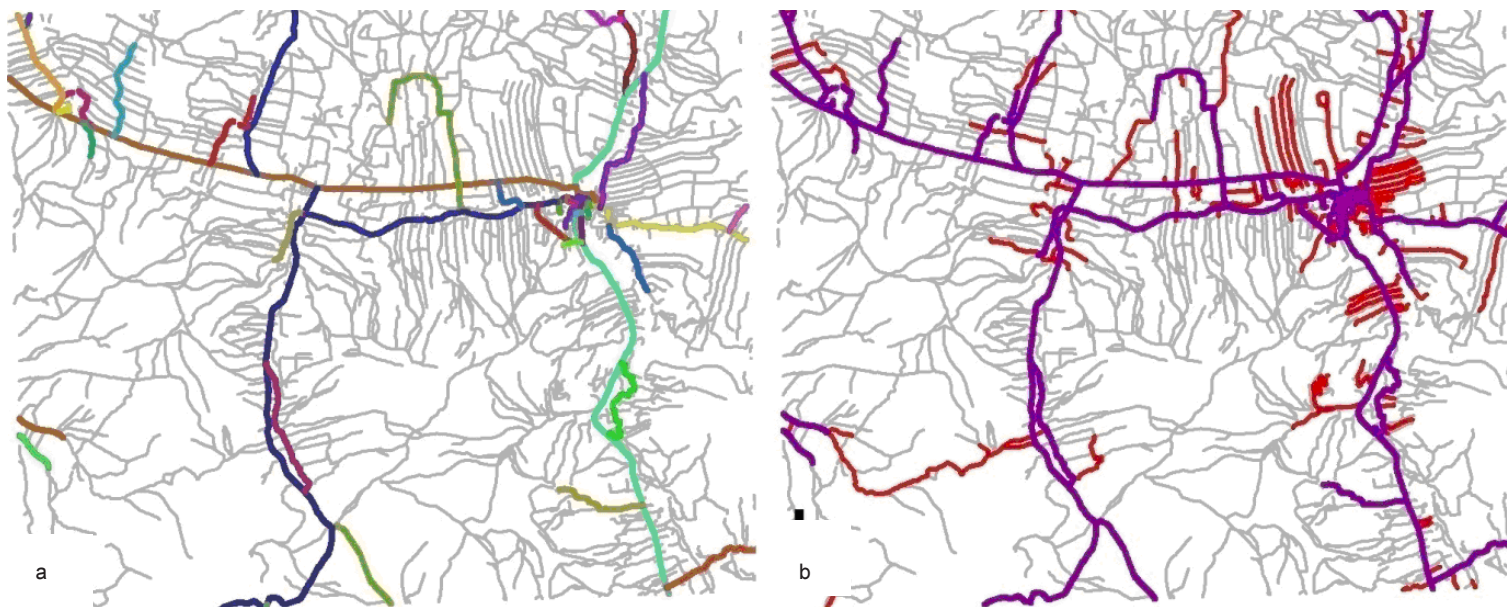
Rys. 3: a – wizualizacja szlaków drogowych, kolorem szarym oznaczono odcinki jezdni których nie przypisano do żadnego ze szlaków, b – fioletowy – drogi o przypisanym szlaku drogowym, czerwony – drogi o nawierzchni innej niż gruntowa, szary – drogi gruntowe
