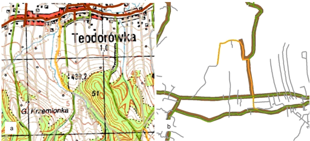
Rys. 5. Nadanie atrybutu decyzyjnego: a – LoD 1: 50 000 (materiały źródłowe w formie rastra mapy topograficznej), b – LoD 1: 250 000 (drogi w BDO – brązowe, szerokie)
