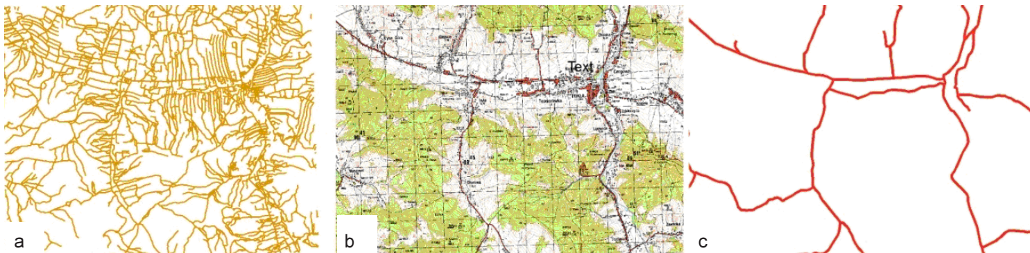
Rys. 2: a – dane źródłowe TBD – odcinki jezdni w klasie SKJZ; dane porównawcze o mniejszej szczegółowości: b – fragment mapy 1: 50 000, c – dane z BDO – drogi
