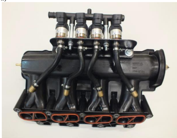
Fig. 1. Intake manifold engine Fiat 1.3 MJT with gas injectors: a) manifold before installation, b) manifold when mounted on the engine Rys. 1. Kolektor dolotowy silnika Fiat 1.3 MJT z wtryskiwaczami gazu: a) kolektor przed montażem, b) kolektor po zamontowaniu na silnik
