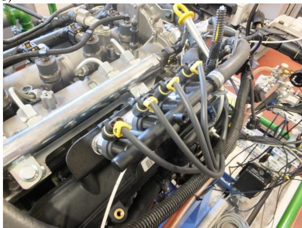
Fig. 1. Intake manifold engine Fiat 1.3 MJT with gas injectors: a) manifold before installation, b) manifold when mounted on the engine Rys. 1. Kolektor dolotowy silnika Fiat 1.3 MJT z wtryskiwaczami gazu: a) kolektor przed montażem, b) kolektor po zamontowaniu na silnik
