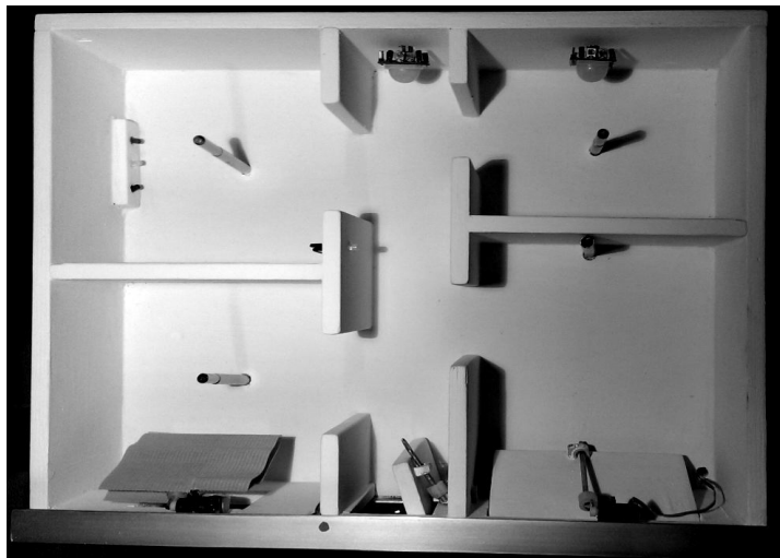
Rys. 2. Makieta inteligentnego domu
