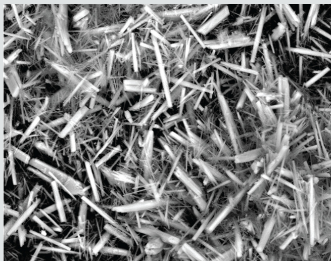
Rys. 3. Zdjęcia SEM otrzymanego hydroksyapatytu (5000 x)
