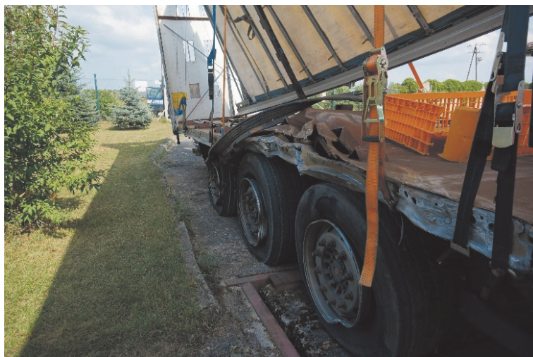
Ryc. 4. Uszkodzenia naczepy powstałe w wyniku uderzenia przez szynobus.
