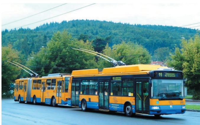
Fot. 1. Na pierwszym planie trolejbus Škoda 24Tr zbudowany na nadwoziu Irisbus Citybus 12M w Zlinie Autor: Marcin Połom
