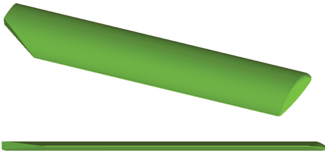
Rys. 5. Model geometryczny łopaty śmigła ogonowego z profilem ILT212 [W. Zalewski, 2015]
