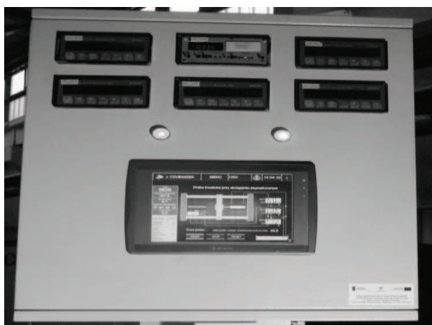
Rys. 6. Pulpit sterowniczy stanowiska do badań podpró hydraulicznych [2]
