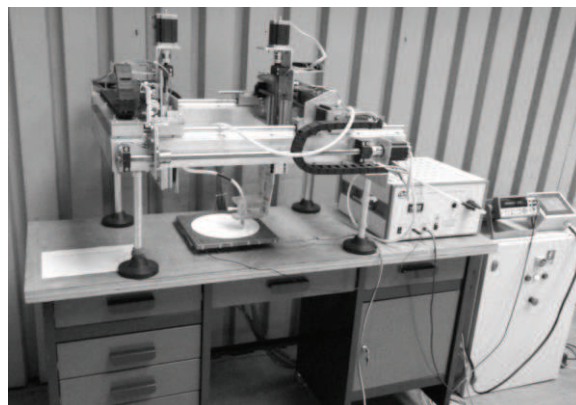
Rys. 13. Skaner potencjału powierzchniowego z unikatowym woltomierzem elektrostatycznym [11]
