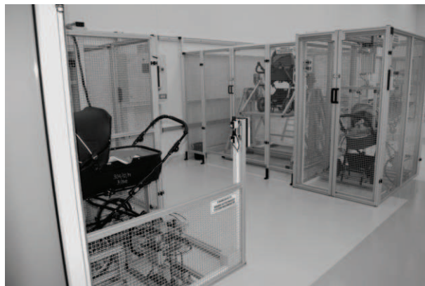
Rys 16. Zespół stanowisk do badań bezpieczeństwa użytkowania wózków dziecięcych [źródło: opracowanie własne]
