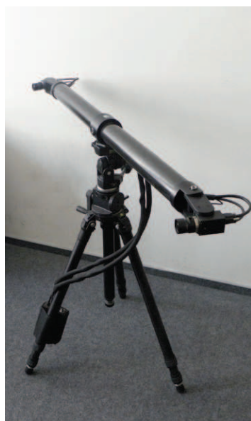
Rys. 2. Stelaż skanera optycznego 3D z układem dwóch kamer
