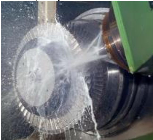
Rys. 2. Proces frezowania bliska na maszynie 5-cio osiowej [16].
