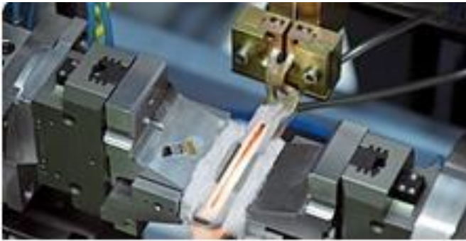
Rys. 8. Proces wykonywania złącza w metodzie IHFP [18].
