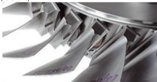
Rys. 7. Pióra i dysk przygotowane do łączenia metodą zgrzewania tarciovego [18].
