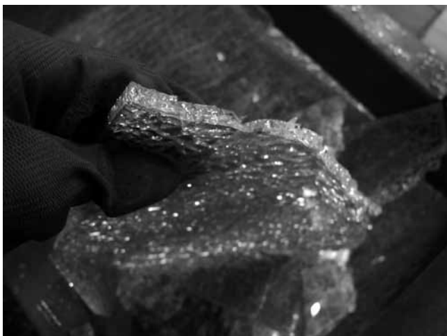
Rys. 6. Siatka spękań szkła hartowanego utrzymująca się dzięki folii przyklejonej przed rozpoczęciem badania [7]
