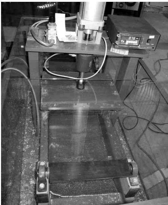
Rys. 4. Miernik CL oraz maszyna wytrzymałościowa [7]
