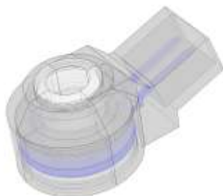
Fig. 9. 3D model of the knock sensor Rys. 9. Model 3D czujnika spalania stukowego
