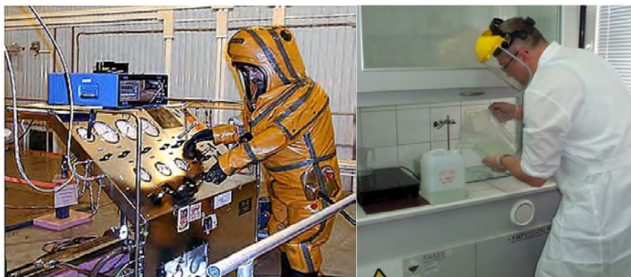
Rys. 6. a) Operacja napełniania zbiornika hydrazyną (Astrium), b) przelewanie 98%+ HTP (ILot)
