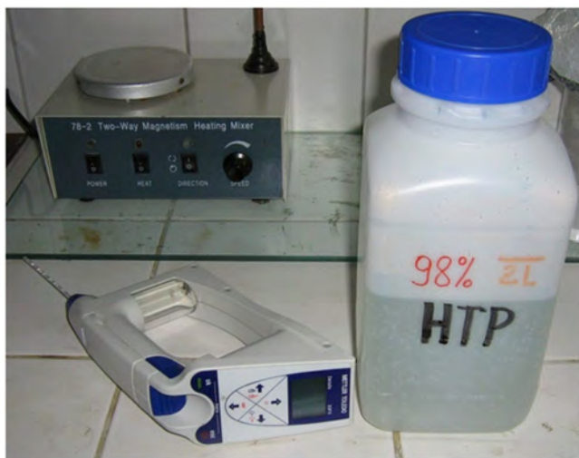
Rys. 3. Elektroniczny, precyzyjny miernik gęstości używany wyłącznie do pomiarów z HTP
