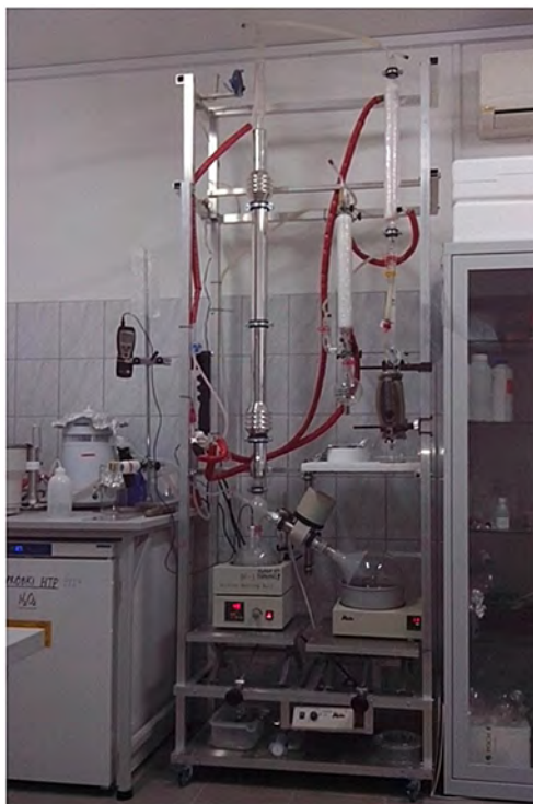
Rys. 4. Aparatura do uzyskiwania nadtlenku wodoru 98%+ dla celów rakietowych
