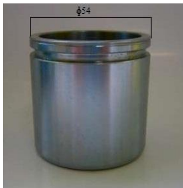
Rys. 7. Tłok zacisku hamulcowego o średnicy \phi 54\text{mm}
