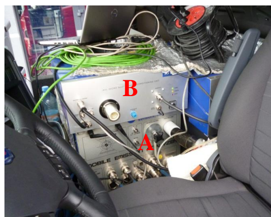
Rys. 5. Mobilne analizatory gazów wylotowych zainstalowane w kabinie pojazdu: a) SEMTECH DS, b) AVL MSS
