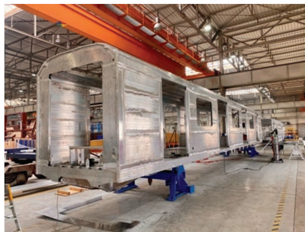
Rys. 15. Aluminiowe pudło dla pociągu metra warszawskiego [fot. M. Tobrman / Škoda]
