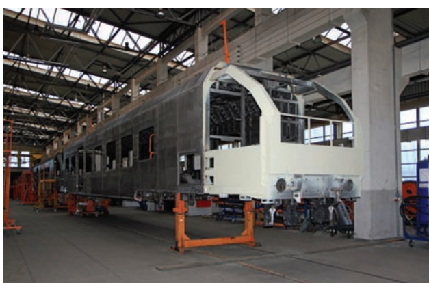
Rys. 5. Pudło zt Impuls, Newag [fot. M. Wojtaszek, 27.12.2016 r.]
