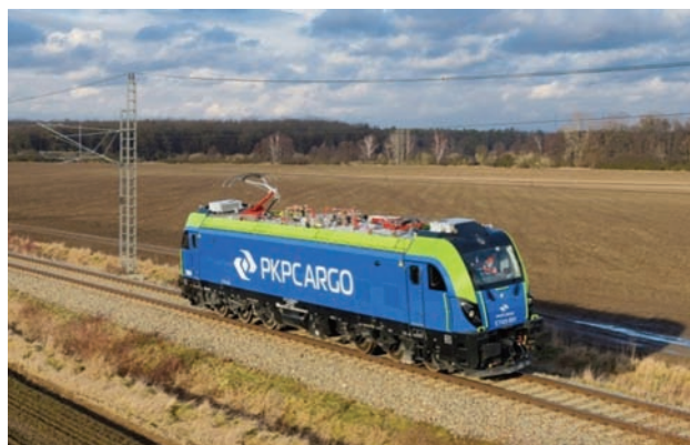
Rys. 6. Lokomotywa Dragon ET43-001 (Newag; 3 kV DC, 25 kV 50 Hz) podczas prób techniczno-ruchowych na torze doświadczalnym w Cerhenicach k. Velimie, Czechy [fot. J. Navratil, 24.01.2021 r.]
