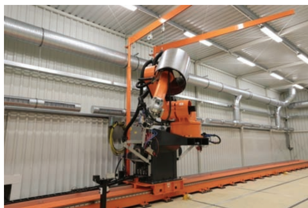
Rys. 3. Robot przemysłowy do spawania laserowego na terenie zakładu Bombardiera we Wrocławiu [fot. M. Kaczanowski / Bombardier, 07.06.2017 r.]
