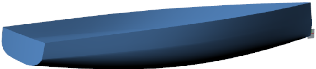
Rys. 1. Model powierzchniowy bryły kadłuba
