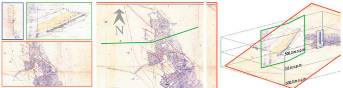
Rys. 7. Przykład korelacji przestrzennej materiałów archiwalnych (kolorem niebieskim oznaczony został profil geologiczny szybu, kolorem zielonym przekrój, kolorem czerwonym mapa jednego z pokładów). Skorelowanie przestrzenne materiałów archiwalnych umożliwia m.in. odtwarzanie budowy geologicznej złoża
