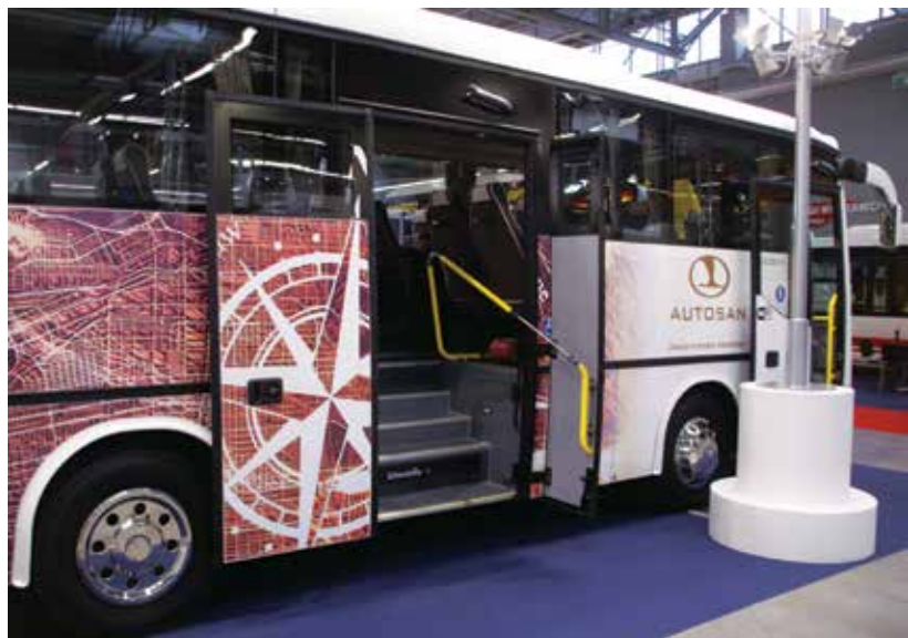
Ciekawy układ drzwi środkowych, umożliwiających wprowadzenie do wnętrza pasażera poruszającego się na wózku inwalidzkim
