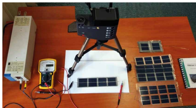
Rys. 11. Stanowisko do badań ogniw słonecznych z wykorzystaniem kamery termowizyjnej
