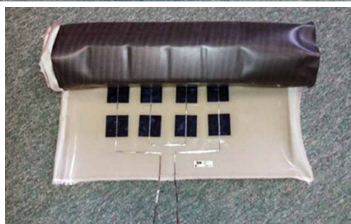
Rys. 14. Prototyp elastycznego pokrycia fotowoltaicznego
