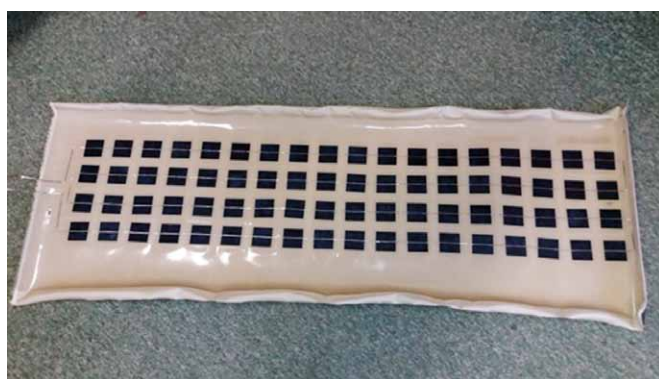
Rys. 14. Prototyp elastycznego pokrycia fotowoltaicznego
