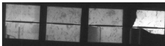
Rys. 10. Obraz elektroluminescencji pokrycia EPF_02 i EPF_05
