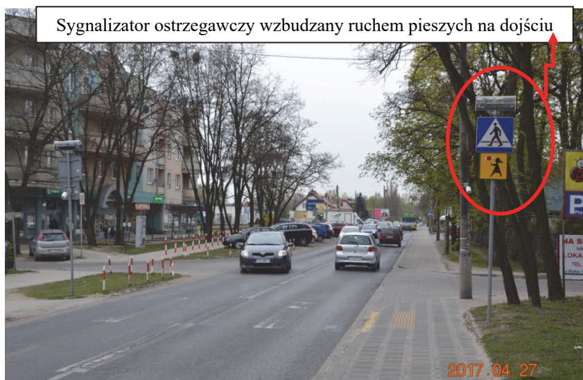
Rys. 1. Przykład sygnalizacji ostrzegawczej wzbudzanej
