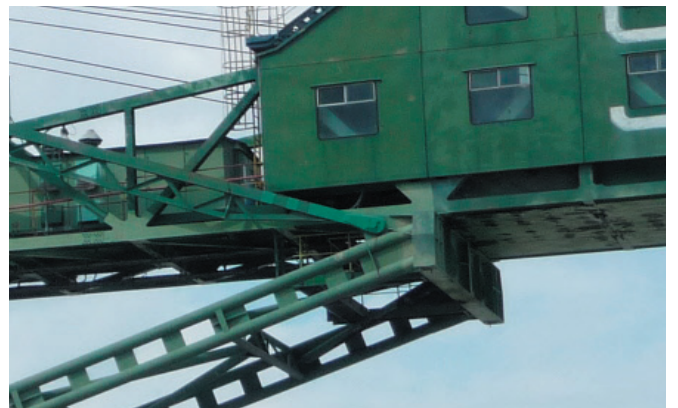
Rys. 5. Podparcie pod skrzynią przeciwwagi – koparka KWK1500
