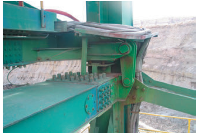
Rys. 4. Podparcie na wieży – koparka KWK1500
