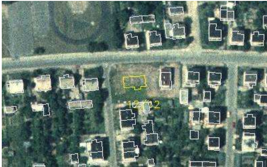
Rys. 6a. Przykłady miejsc wskazanych przez system jako elementy usunięte – wskazanie poprawne
