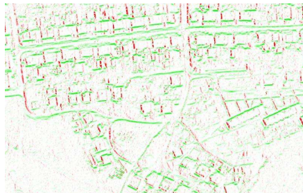
Rys. 4. Złożenie efektów wskazania wzajemnie prostopadłych krawędzi
