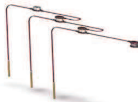
Rys. 6. Schemat wykonywania połączenia zapalników w systemie HotShot [10]
